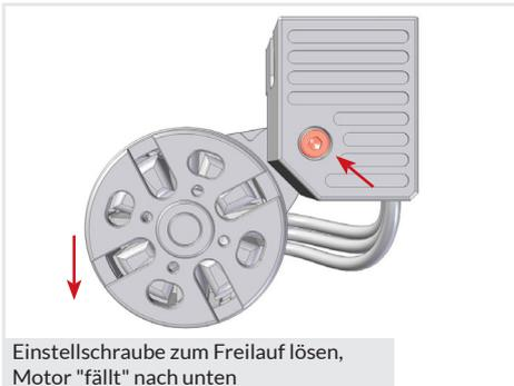
3. Beträgt der Abstand weniger als 2-5 mm, die Einstellschraube zum Freilauf (3) um eine Umdrehung lösen. Es ist nicht notwendig die Schraube komplett herauszuschrauben.
