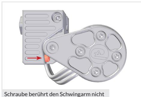
Die Einstellschraube für den unteren Anschlag (4) so weit herausdrehen, dass die Schraube den Schwingarm im ausgekoppelten Zustand **gerade nicht** berührt.
