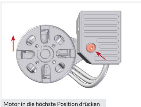
4. Den Motor bis zum Anschlag hochdrücken und die Einstellschraube (3) **in dieser Position** handfest anziehen.
