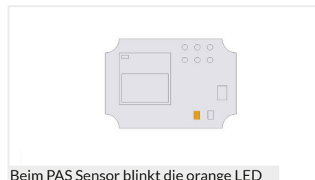
Beim PAS Sensor blinkt die orange LED
